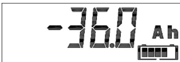
La quantità di Ah consumati dalla batteria. Durante la ricarica, gli Ah consumati diminuiscono fino a portarsi al valore 0 Ah (batteria carica).
