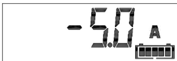
La corrente in uscita dalla batteria (segno negativo) o in entrata verso la batteria (segno positivo).
