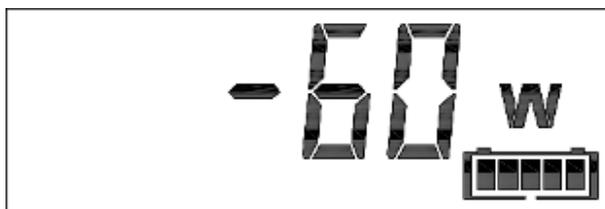
La potenza in uscita dalla batteria (segno negativo) o in entrata verso la batteria (segno positivo).
