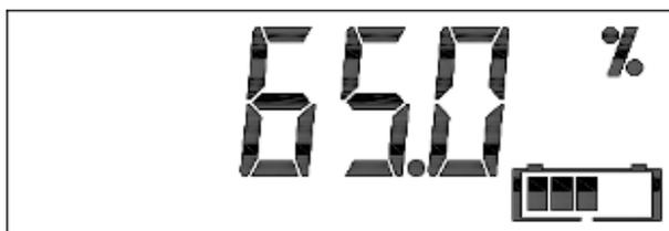
Una batteria completamente carica mostra un valore pari a 100,0%. Per una batteria completamente scarica il valore sarà 0,0%.
