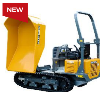
CARRY 150/230 Capacity 1500kg/ 2300kg Unit Weight 860kg/ 2285kg Kubota D902 20.0 Hp / V1505 24.8 Hp
